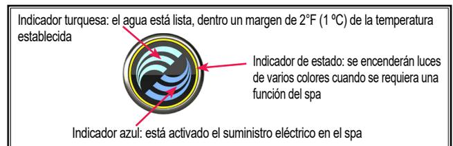
**Indicador turquesa de listo:** el indicador TEAL se ilumina cuando la temperatura del agua del spa está a +/- 2 °F (1 °C) de la temperatura establecida y se apaga cuando dicha temperatura se sale de estos límites. Si se aumenta o disminuye el nivel de temperatura del spa, el indicador de Ready se apagará hasta que la temperatura del agua alcance el límite aceptable para la nueva configuración de la temperatura.
