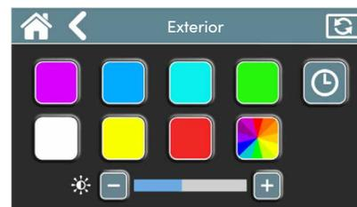
La zona exterior es la única zona de iluminación que se puede programar para que se encienda a una hora específica del día, así como el tiempo durante el cual permanecerá encendida (de 1 a 6 horas). Pulse en el menú iluminación exterior para acceder a la pantalla de configuración de la hora y la duración.
